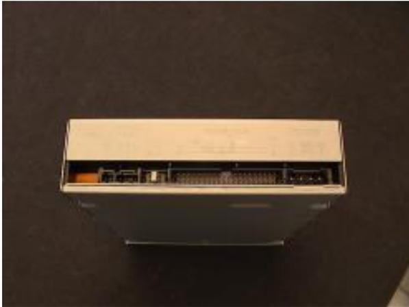
Hier ist beispielsweise die Rückseite unseres DVD-Laufwerks. der Anschluss für das Datenkabel befindet sich in der Mitte und der Anschluss für die Stromversorgung rechts.
