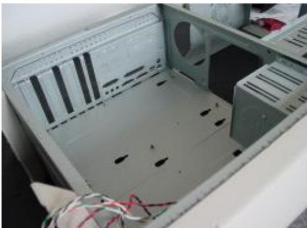
Diese werden nun an den Seiten und Kanten eingeschraubt, wo nachfolgend das Motherboard befestigt werden soll.
