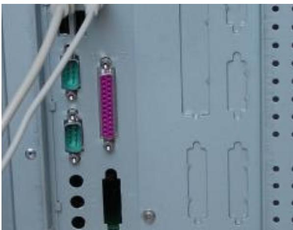
Die zwei aquafarbenen Anschlüsse sind serielle Anschlüsse für verschiedenste Geräte, wie z. B. Modem oder Datenlesegeräte. Die zwei schwärzeren, rechteckigen Anschlüsse zwischen den PS2 und den seriellen Anschlüssen nennt man USB (universal serial bus). Hierbei handelt es sich um einer modernere und praktischere Möglichkeit für jede Art von Peripheriegeräten. Die leeren Öffnungen weiter unten sind die Öffnungen für eine onboard Soundkarte.
