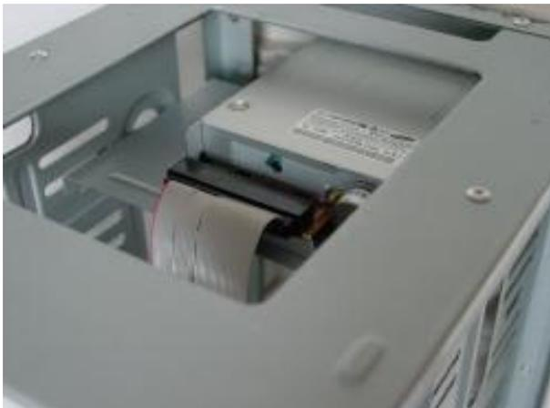
?und das kürzere Ende wird an das Floppy-Laufwerk angeschlossen.
