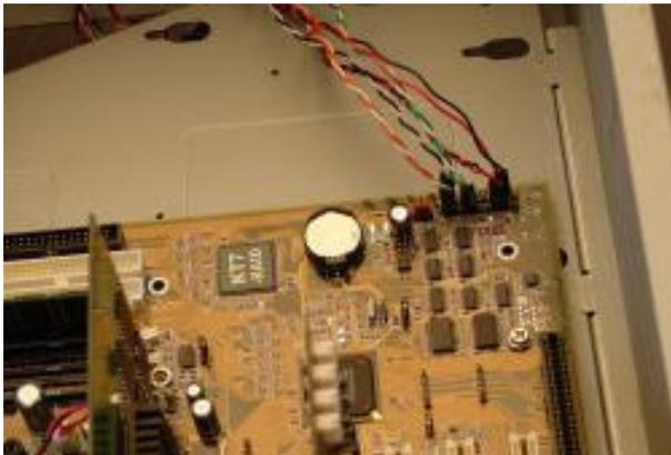
Wenn sämtliche Kontakte Stifte mit den Kabeln des Gehäuses verbunden sind, sieht das Ganze ungefähr wie auf diesem Bild aus.
