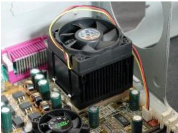
Nun wird der Lüfter auf dem Prozessor befestigt und am Sockel festgemacht. Das Stromkabel wird an dem Anschluss auf dem Motherboard angeschlossen.
