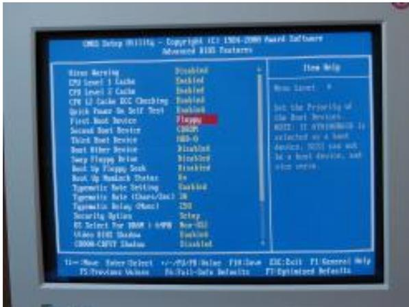
Und eine weitere Bildschirmanzeige (in diesem Fall die "Advanced BIOS Features") ermöglicht es Ihnen, die Boot-Reihenfolge des Computers selbst zu bestimmen. Das heißt, Sie können festlegen, auf welches Gerät der Computer zuerst zugreifen soll, um ein Betriebssystem zu erkennen.
