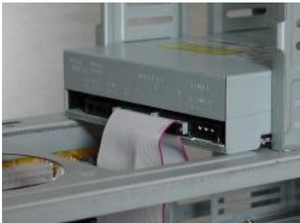
Schließen Sie den mittleren Stecker des Kabels (Slave) an Ihr CD-Laufwerk.
