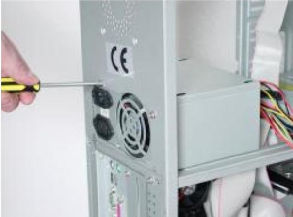
Der nächste Schritt besteht darin, das Netzteil mit den verschiedenen Komponenten zu verbinden. So weit noch nicht vorhanden schrauben Sie das Netzteil in ihre Gehäuse ein.
