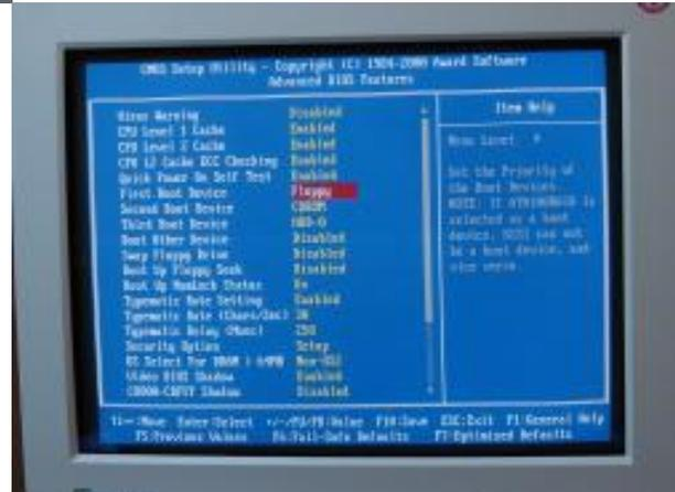
Die zweite Abfrage (Second Boot Device) geht dann über das "CD-ROM" Laufwerk (hierdurch können wir später Windows direkt von CD installieren). Und als Drittes bestimmen wir die Festplatte, auf der schlußendlich das Betriebssystem (also in der Regel Windows) installiert ist: "HDD-0". Nun wählen Sie "quit and save settings", um die Einstellungen zu speichern und den Computer automatisch neu zu starten.
