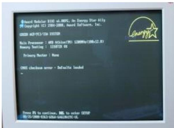
Schalten Sie den Computer ein. Daraufhin werden Sie eine Anzeige wie die Obere sehen. Hier werden Sie dazu aufgefordert, die Entfernen-Taste zu drücken, um die erwähnten Einstellungen vorzunehmen. Drücke Sie also die Entfernen-Taste.
