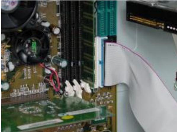
Schließen Sie das lange Ende des IDE-Kabels nun an den IDE1-Anschluss auf dem Motherboard.
