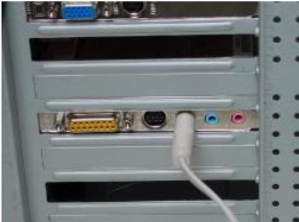
Nur beim Anschluss der Kabel fangen wir von unten an und arbeiten uns dann weiter hinauf. Der gelbe Anschluss auf der Soundkarte ist der "game port", hier schließt man insbesondere einen Joystick an. Der grüne Stecker ist für Computer-Lautsprecher gedacht.
